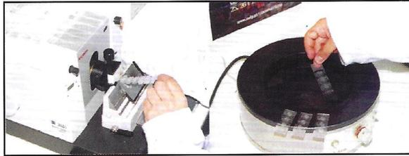
Figura 7. Corte con microtomo y recogida de cortes.
