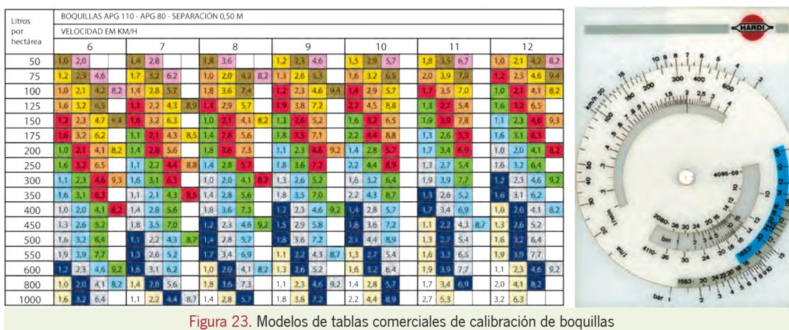
Figura 23. Modelos de tablas comerciales de calibración de boquillas
