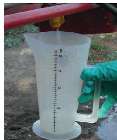
Figura 7. Medida del caudal de una boquilla
