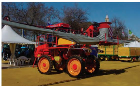
Figura 2. Pulverizador asistido por aire (zancudo)
