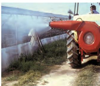
Figura 5. Cañón o pulverizador hidroneumático
