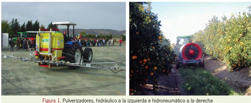
Figura 1. Pulverizadores, hidráulico a la izquierda e hidroneumático a la derecha
