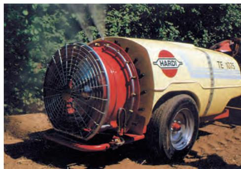
Figura 13. Pulverizador hidroneumático o atomizador
