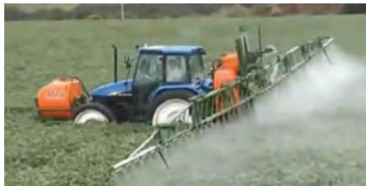
Figura 4. Los pulverizadores hidráulicos deben incluirse en el censo de vehículos a inspeccionar
