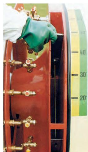
Figura 14. Barra portaboquillas en un pulverizador hidroneumático
