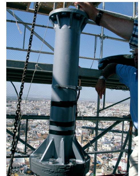
Figura 11.3. Instalación de acelerómetros colocados sobre el carrete
