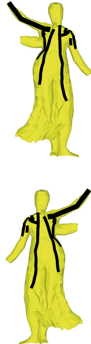
Figura 7.12. Esquema del diseño del nuevo sistema de refuerzo interno (vista delantera y trasera)
