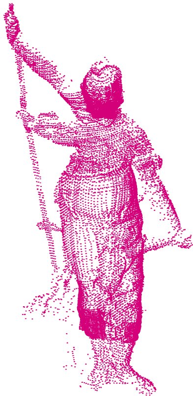
Figura. 5.4. Fotogrametría del Giraldillo realizada por A. Almagro (Escuela de Estudios Árabes, Granada)
