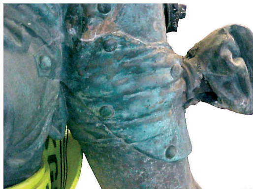
Figura 7.1. El desmontaje de apósitos permitió apreciar con claridad el estado de conservación de la lámina de bronce en esas zonas
