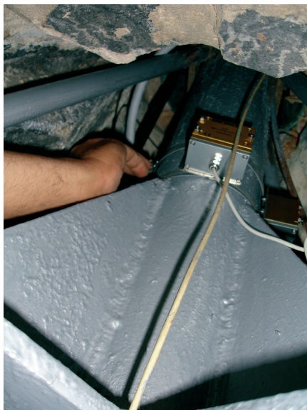
Figura 11.4. Instalación de clinómetros por encima de la cruceta superior del Cuerpo del Penacho.
