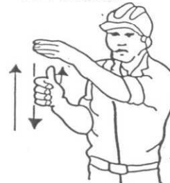
4 Levantar el aguilón o pluma lentamente
