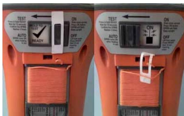
Figura 5. Fotos de EPIRB, la primera precintada y desconectada y la segunda sin precinto y preparada para su activación
