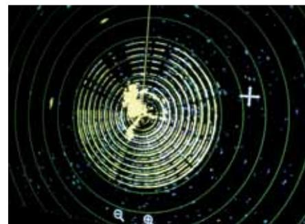
Figura 5. SART detectado en pantalla radar
