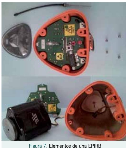
Figura 7. Elementos de una EPIRB
