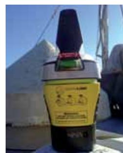
Figura 6. Radiobaliza EPIRB
