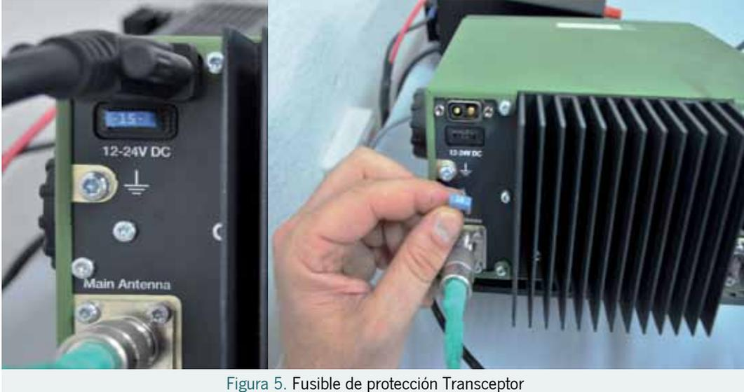
Figura 5. Fusible de protección Transceptor
