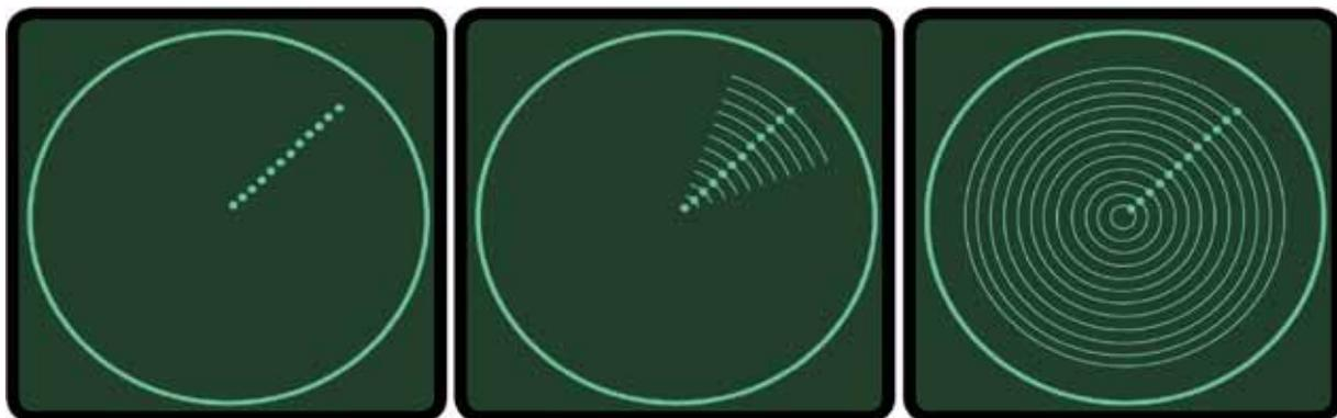
Figura 4. Señales SART visualizadas en un radar banda X a diferentes distancias
