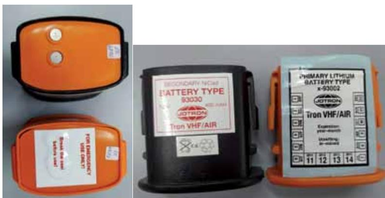
Figura 4. Baterías para portátil GMDSS de VHF
