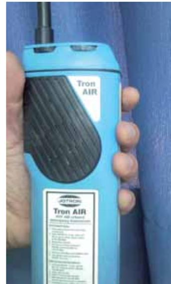
Figura 5. Portátil SAR de Banda Aeronáutica de 121,5 MHz
