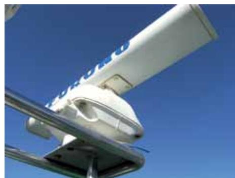
Figura 3. Antena radar banda X
