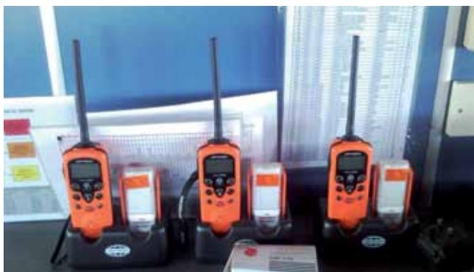
Figura 2. Equipo completo Portátil VHF-SAR
