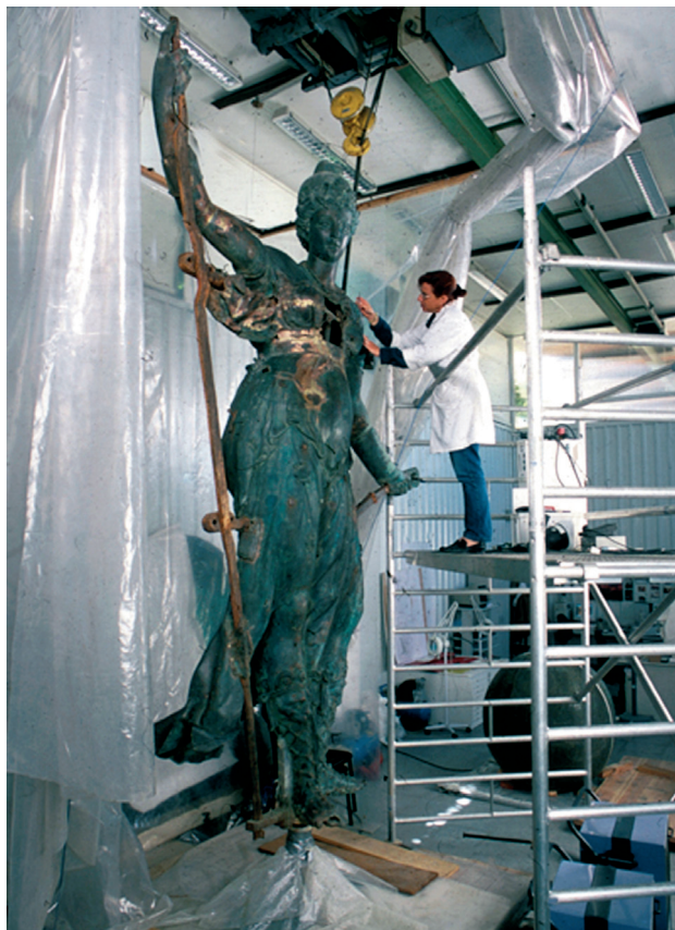
Fig. 1.5. Análisis de la composición del bronce del Giraldillo mediante lupa binocular por D. José María Gallardo. (Foto: IAPH, José Manuel Santos Madrid)
