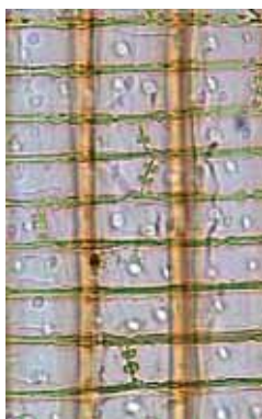
3. Abies sp. Arriba: secciones transversal y tangencial. Abajo: sección radial con el campo de cruce. Radio de la rota restaurada. Imagen: M.T. López de Roma
