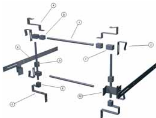
15. Despiece de uno de los anillos de refuerzo transversal y las barras laterales
