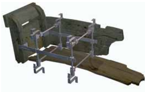
24. Montaje de uno de los cangilones eliminando algunas tablas
