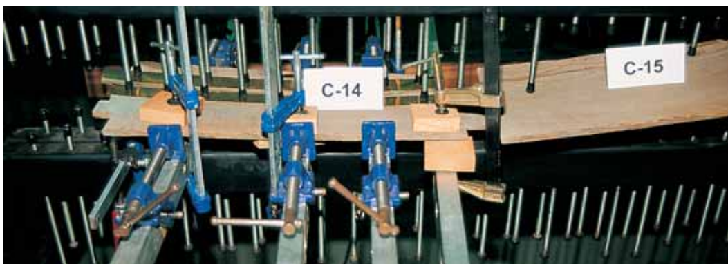
46. Unión de piezas en la tabla de contorno interior del cangilón nº 14
