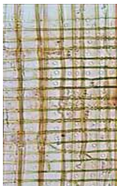
3. Abies sp. Arriba: secciones transversal y tangencial. Abajo: sección radial con el campo de cruce. Radio de la rota restaurada. Imagen: M.T. López de Roma
