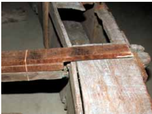
27. Sistema de sujeción de los radios a los cangilones
