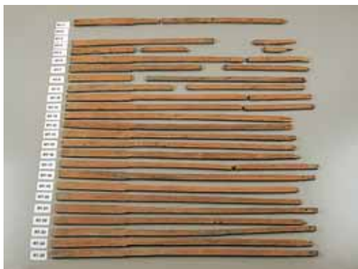
44. Conjunto de radios traseros después de los tratamientos
