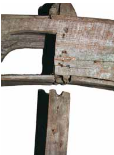
23. Aserrado de un radio al cangilón
