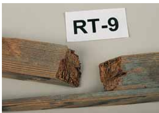
41. Fractura en el radio trasero nº 9
