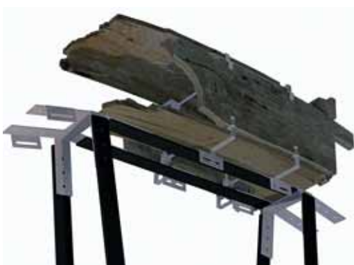
25. Fijación del cangilón a la estructura principal de sustentación
