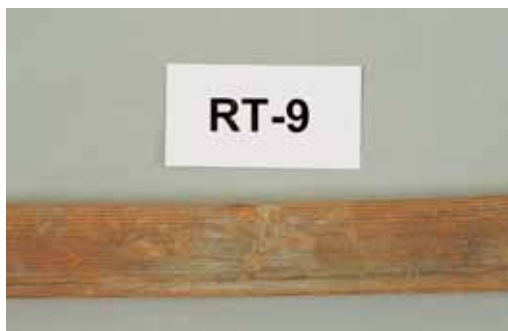
42. Consolidación de la fractura en el radio trasero nº 9
