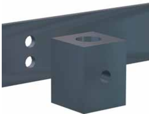
21. Pieza de fijación de la pletina lateral a los tubos
