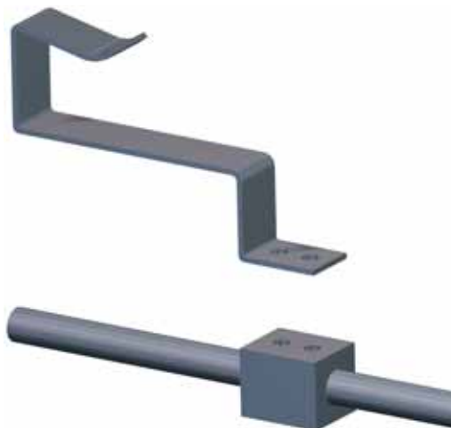
19. Pieza de fijación a la estructura principal
