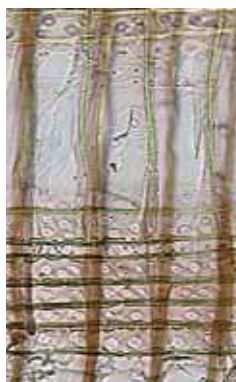
2. Pinus pinaster Sol in Aitor. Arriba: secciones transversal y tangencial. Abajo: sección radial con el campo de cruce. Disco de la rota restaurada. M.T. López de Roma
