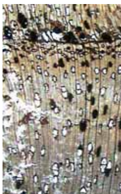
1. Arriba: sección transversal y tangencial de Quercus sp. Abajo: sección transversal y vaso de Fraxinus angustifolia Vahl. Clavijas de la rota restaurada. Imagen: M. T. López de Roma
