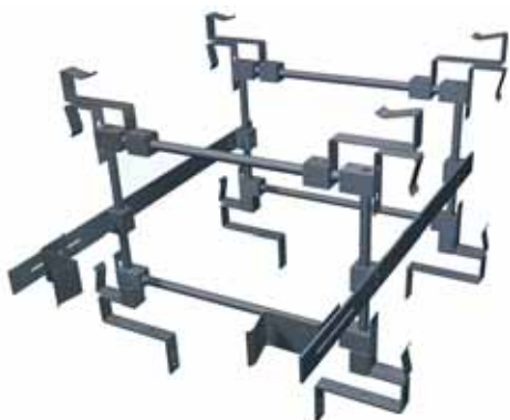
14. Estructura interna de sujeción de los cangilones. Diseño final
