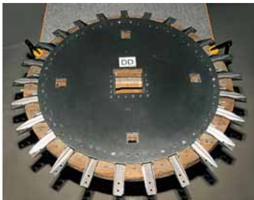
53. Colocación de las piezas metálicas que sujetaran los radios de fibra de carbono en el disco dentado trasero
