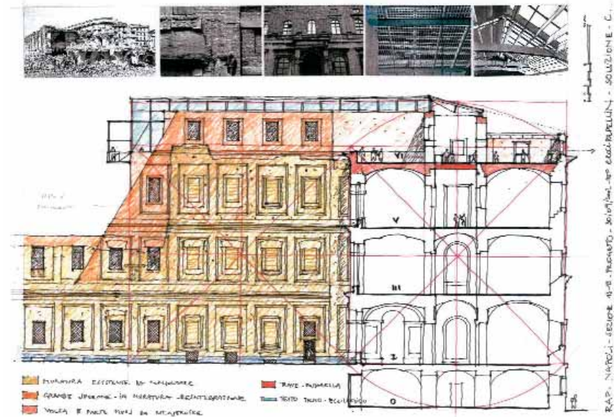
Coupe transversale, premier projet «hypothèse C/2002». Solution avec nouvelles voûtes en briques, verrière PV et passerelle dans le couloir. Les voûtes sont positionnées au «niveau Fuga», ainsi la terrasse devient une grande chambre à ciel ouvert, qui offre des vues sur la ville à travers les fenêtres de l'attique. Dibujo: Nicolas Detry, 2002
