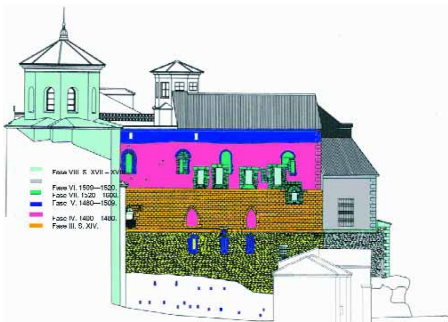
Análisis estratigráfico en colores de los cuerpos de fábrica 1 y 2. Fuente: Proyecto de restauración y rehabilitación de la Catedral de Cuenca
