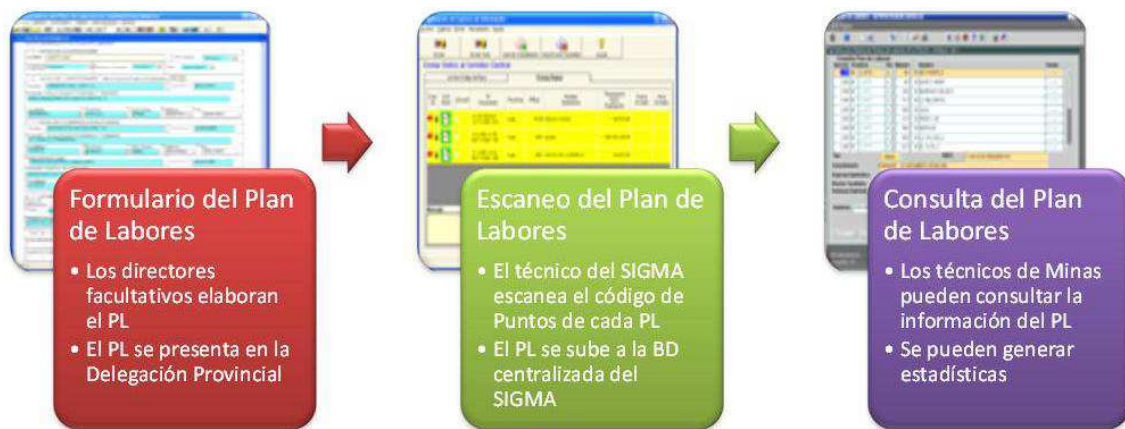
Gráfico 10. Esquema de funcionamiento del nuevo sistema del plan de labores en pruebas.
