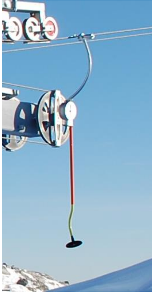
Imagen 12. Vehículo completo típico monoplaza, con pinza, brazo, tambor y asiento de plato.
