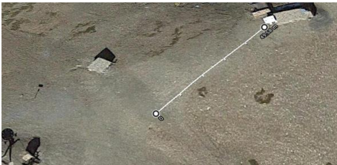
Imagen 7. Trayectoria de la acometida eléctrica para la caseta de la Estación Superior del nuevo telesquí El Puente.
