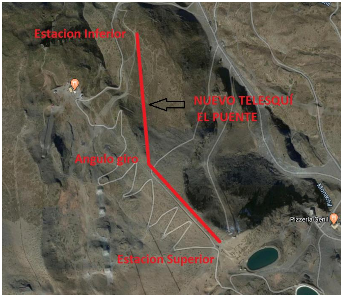
Imagen 2. Situación de las estaciones y el ángulo de giro (estación intermedia) para el nuevo telesquí El Puente y línea de nieve asociada en su parte inicial.
