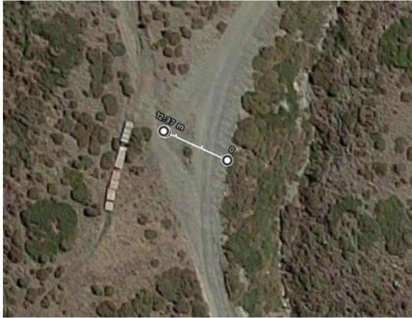
Imagen 4. Trayectoria prevista para la línea en MT de la estación inferior del nuevo telesquí El Puente.
