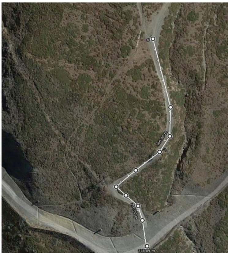
Imagen 5. Trayectoria prevista para la línea de abastecimiento y saneamiento de la estación inferior del telesquí El Puente.
