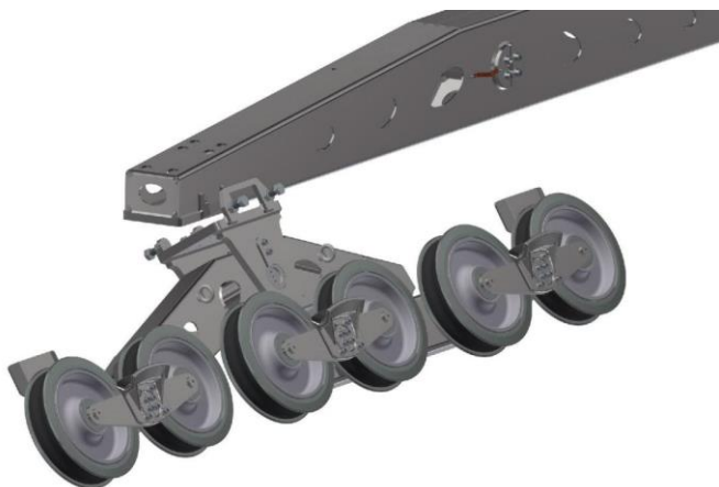
Imagen 11. Balancín típico de una instalación.
