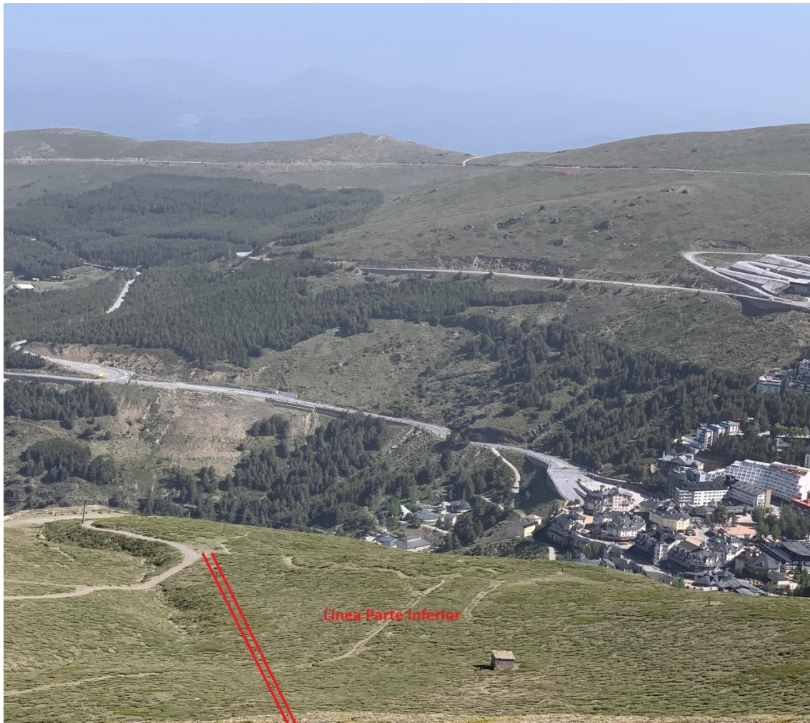
Imagen 6. Trayectoria prevista para el Telesquí El Puente, en su parte inferior o tramo 1, el cual debe innivarse con las instalaciones de nieve producida a construir.
