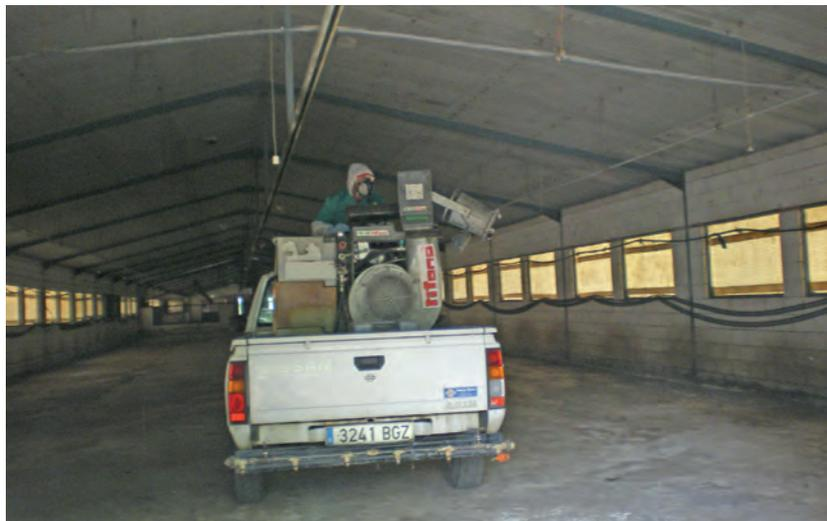
Figura 9. Sistema de pulverización móvil
