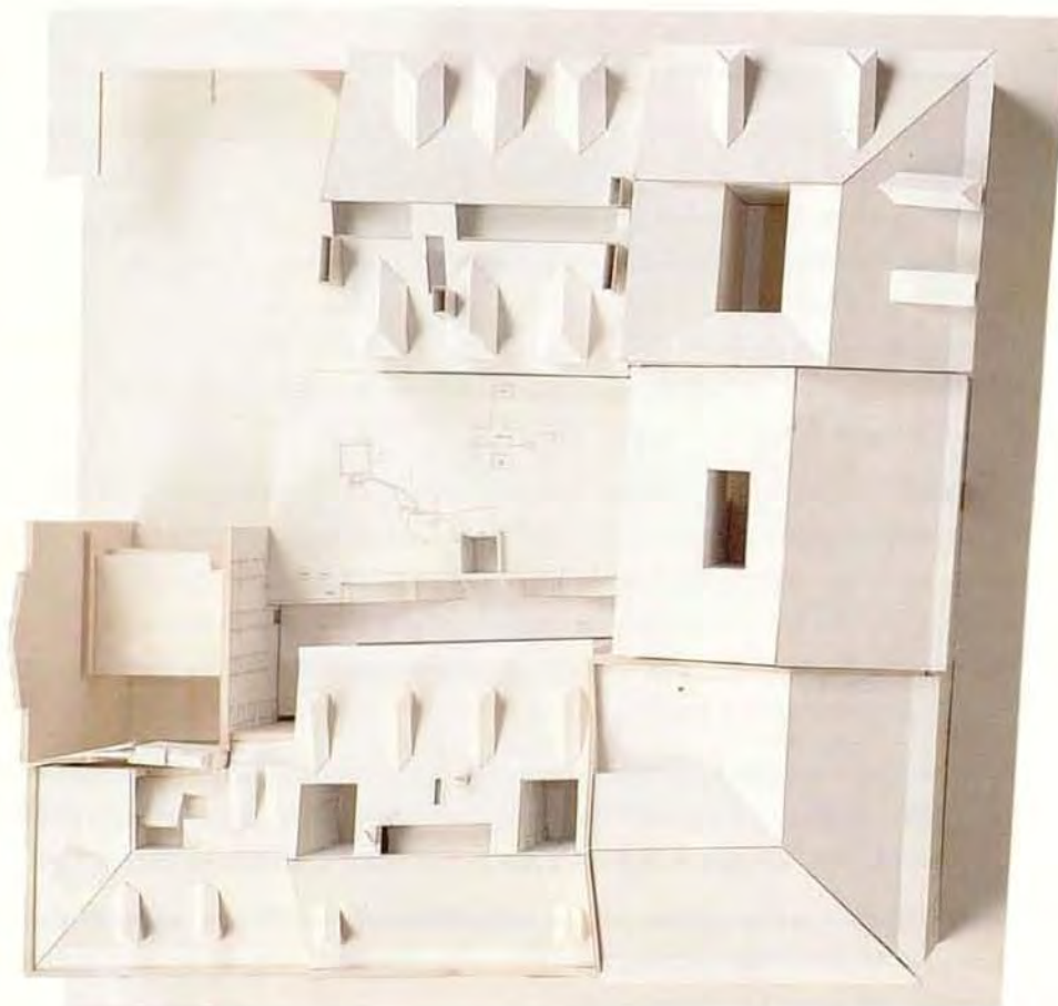
Maqueta del Bloque A de la propuesta. En primer término, perforando la edificación, el acceso al patio desde la escalinata de la Rua São Francisco. Al fondo, la perforación en el edificio Jerônimo Martins permite la comunicación con la Rua Garrett.
