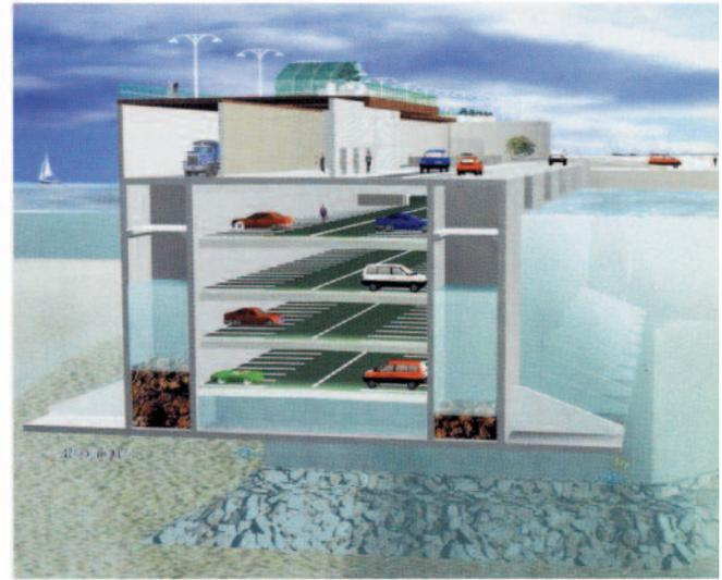
Sensiblemente orientado en la dirección Norte-Noreste, el cajón sólo tendrá tres de seis grados de libertad posibles en un sólido flotante.
