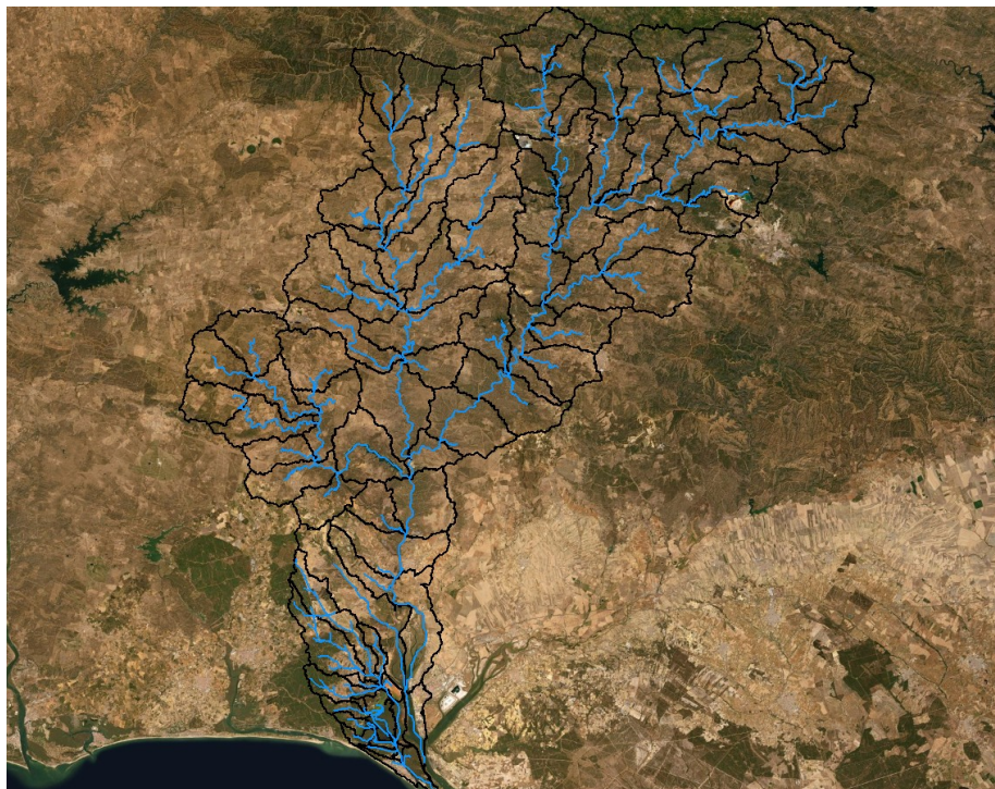
Fig. 9. División en subcuencas de una cuenca de estudio mediante la extensión HEC-GeoHMS. Ejemplo: cuenca del río Odiel. (Fuente: elaboración propia).
