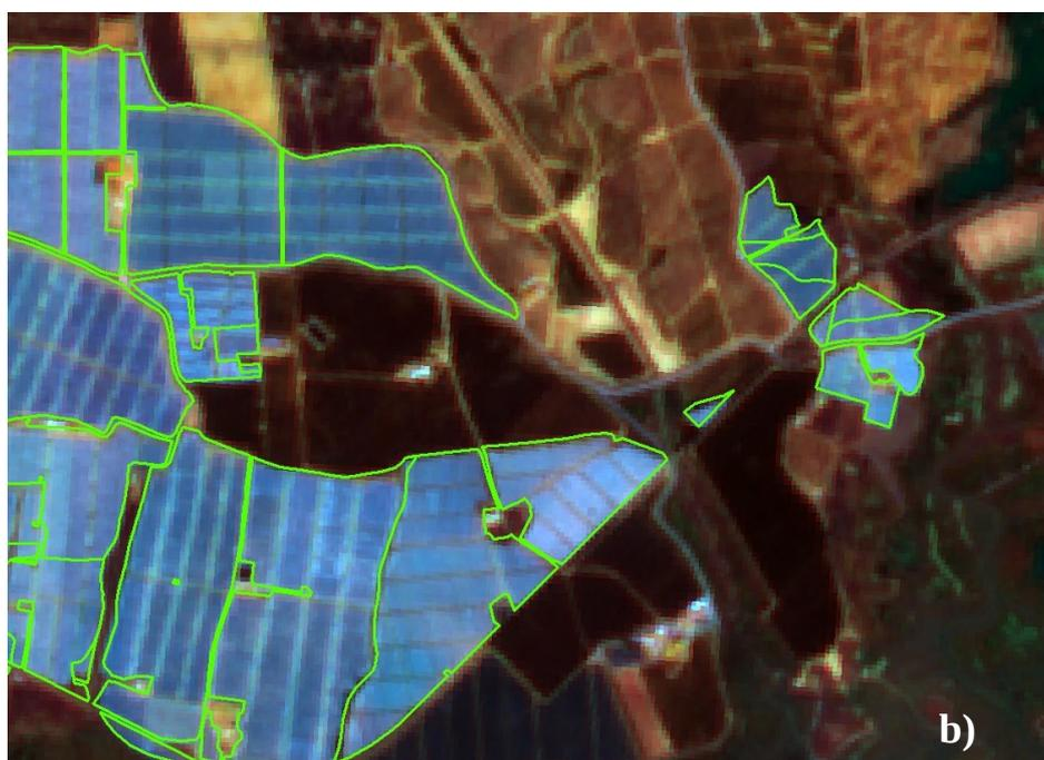
**Figura 4.** Se muestran detalles de: cobertura de plástico detectado automáticamente sobre escena SENTINEL del 11 de enero (a) y cartografía de cultivos bajo plástico generada tras el proceso de revisión con base geométrica SigPac, sobre escena del 15 de febrero (b).
