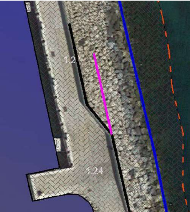
Vista en negro, alineación actual, en magenta, alineación propuesta.
