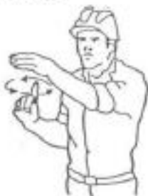
3 Levantar la carga lentamente
