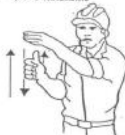
4 Levantar el aguilón o pluma lentamente
