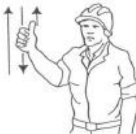
4 Levantar el aguilón o pluma lentamente
