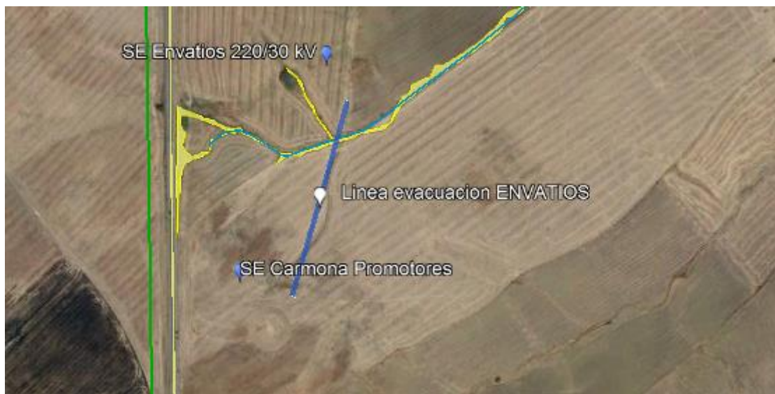
FIGURA 3: TRAZADO DE LA LÍNEA DE ALTA TENSIÓN.
