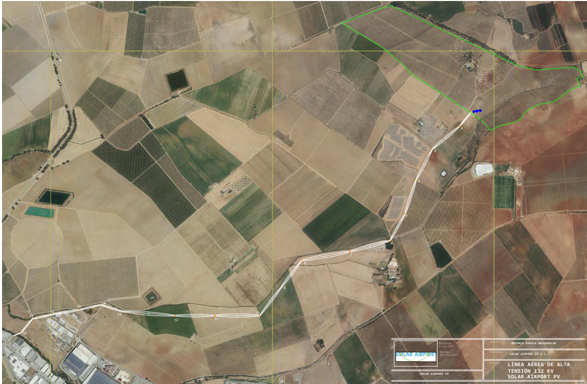
Ilustración 16: Trazado de la línea de Evacuación
