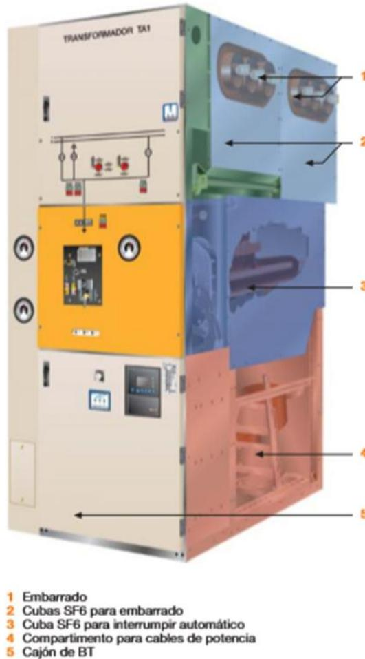
Ilustración 3. Celda de MT MESA CBGS-2 52 kV.
