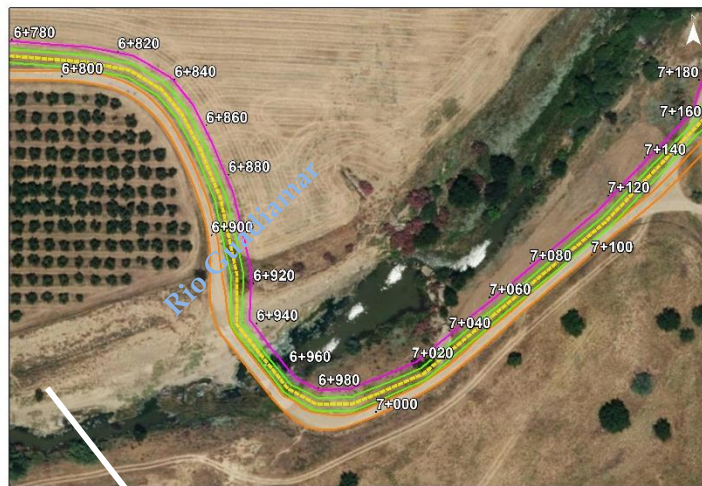
Figura 5.28 Cauce del río Guadiamar en el punto de cruce con la infraestructura proyectada. Se aprecia en la margen derecha la eliminación de la vegetación tras movimientos de tierra realizados recientemente
