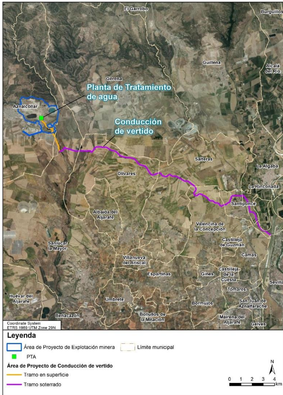
Figura I.1 Localización del área de proyecto de la explotación minera y de la conducción y detalle de su trazado hasta el río Guadalquivir
