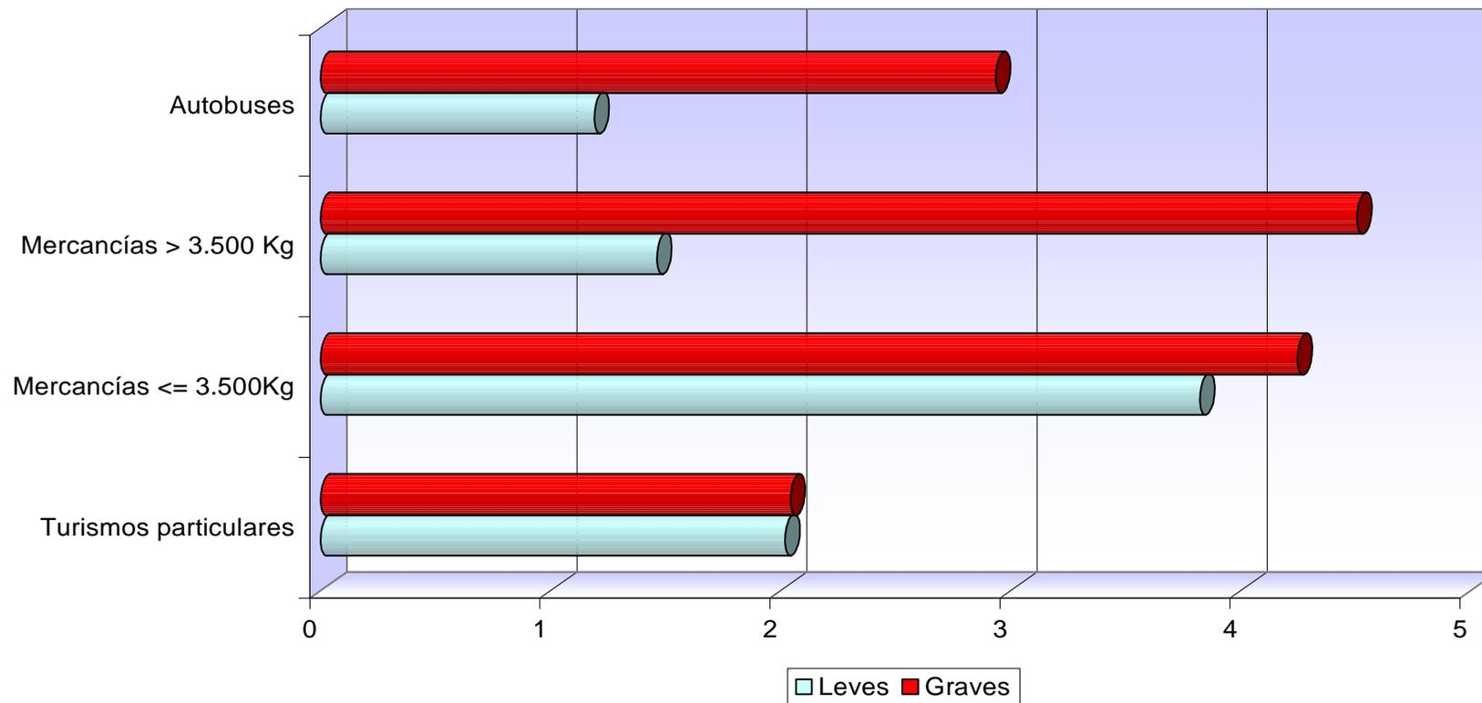
5.2.12. Gráfico. Defectos en ejes, ruedas, neumáticos y suspensión. Índice de defectos
