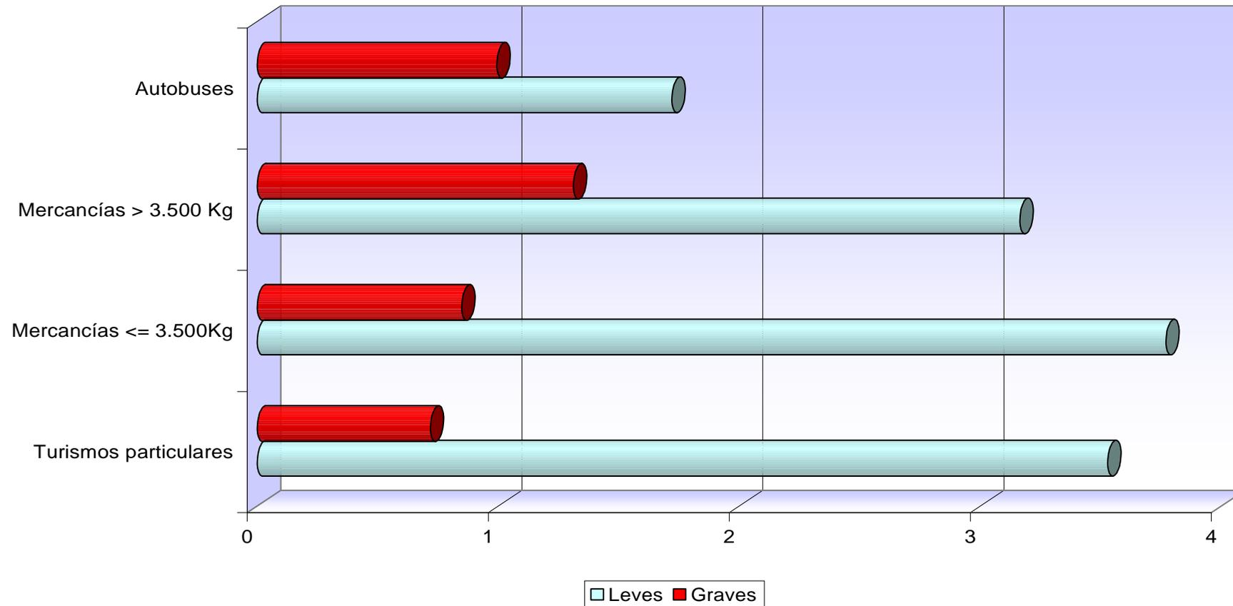
5.2.6. Gráfico. Defectos en el acondicionamiento exterior, carrocería y chasis. Índice de defectos
