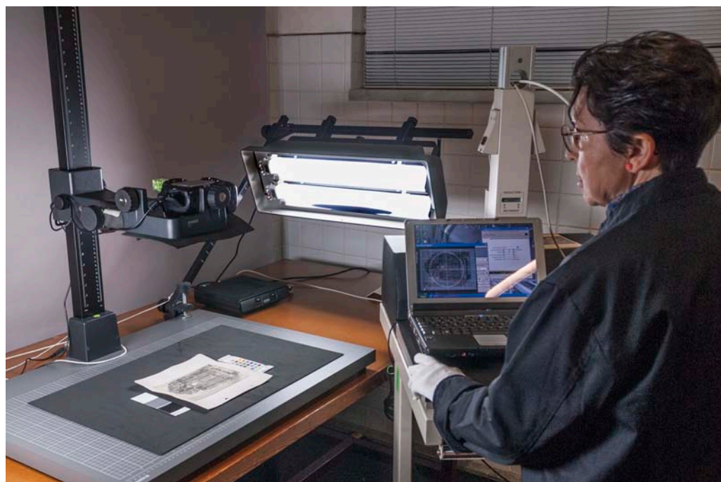
Digitalización con cámara y mesa de reproducción. Foto: Fondo Gráfico IAPH (Teresa Rubio Lara)
