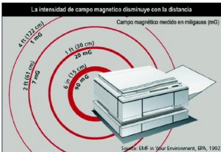
Figura 3.2 Ilustración de la disminución de la intensidad de campo magnético
