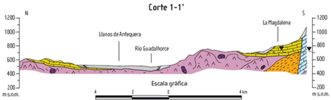
Figura nº 4. Corte geológico de la masa de agua subterránea. Fuente: Atlas Hidrogeológico de la provincia de Málaga.
