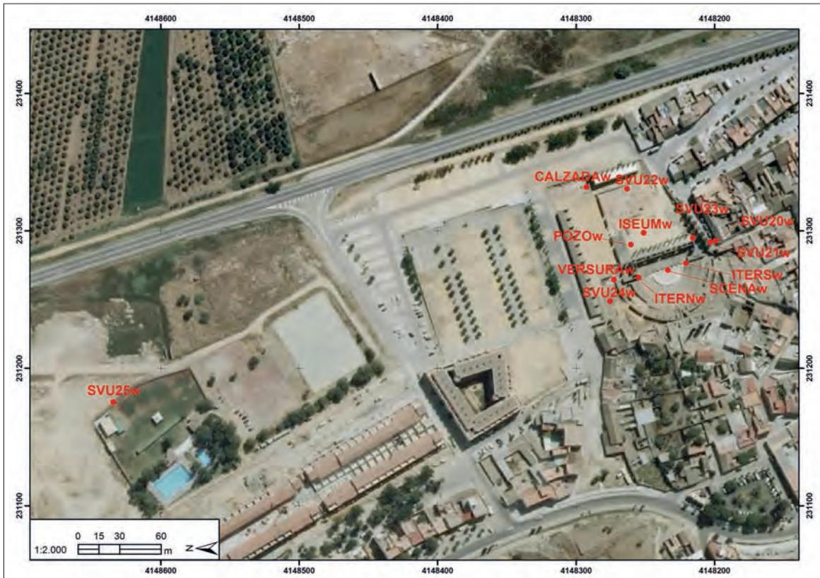
Fig. 4.- Localización de sondeos mecánicos dotados de piezómetros y otros puntos de muestreo de aguas utilizados en la presente investigación. Campaña de octubre de 2011: (SVU-20w a SVU-25w).
