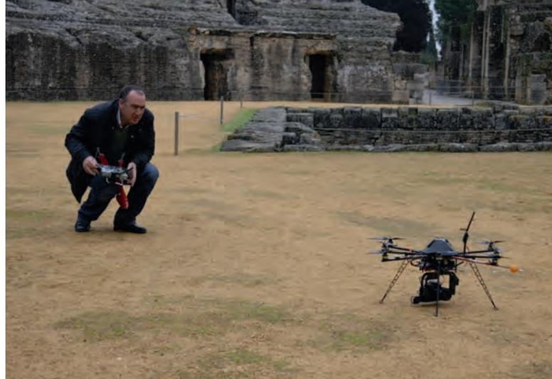
Fig. 8.- Utilización de DRON para la toma de fotos cenitales como apoyo al trabajo de dibujo y levantamiento topográfico del anfiteatro.
