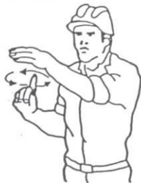
3 Levantar la carga lentamente
