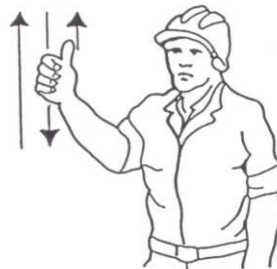
4 Levantar el aguilón o pluma lentamente
