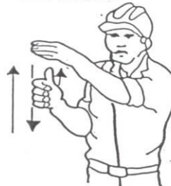
4 Levantar el aguilón o pluma lentamente
