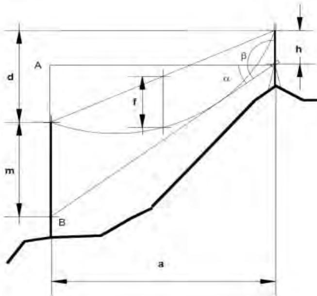
El ángulo  $\beta$  a marcar, con taquímetros cuyo origen de ángulos esté en la vertical ascendente, será:
