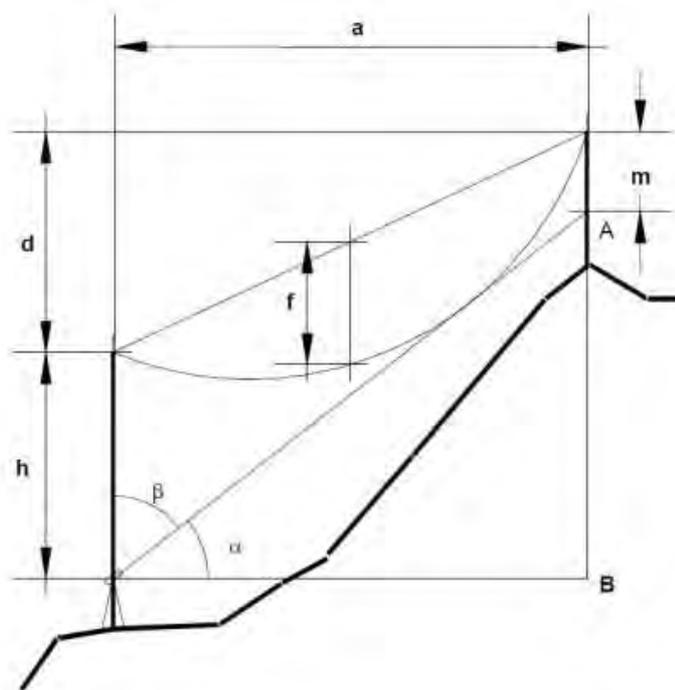
El ángulo  $\beta$  a marcar con taquímetros cuyo origen de ángulos, esté en la vertical ascendente será:
