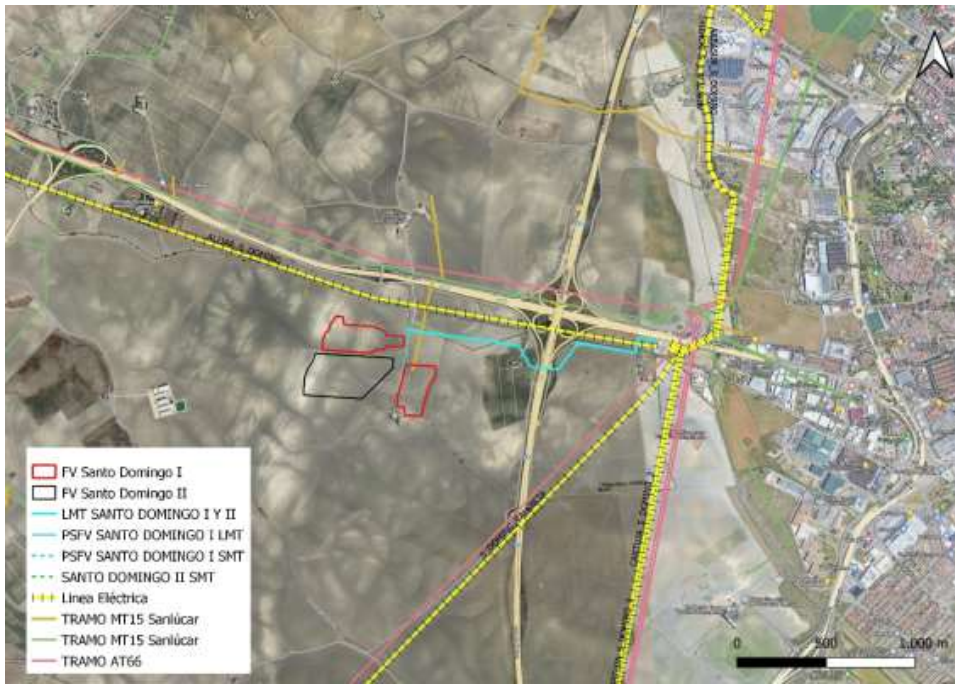
Ilustración 15 Zona de actuación y red eléctrica
