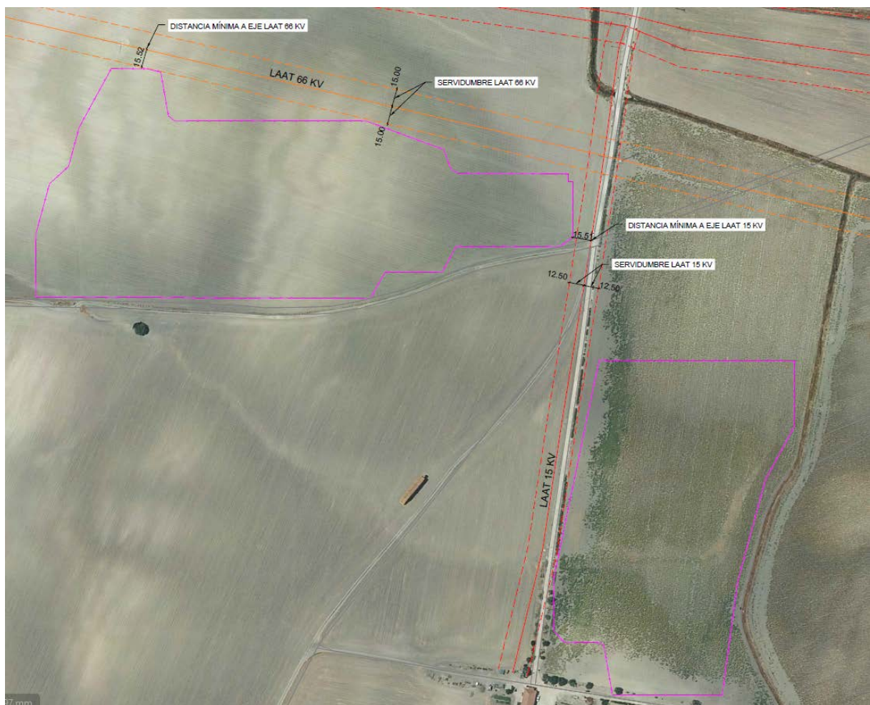
Imagen 3 Vista aérea del recorrido de la línea eléctrica existente y servidumbre
