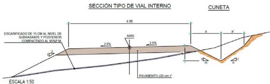
Ilustración 16: Sección tipo de vial interno.
