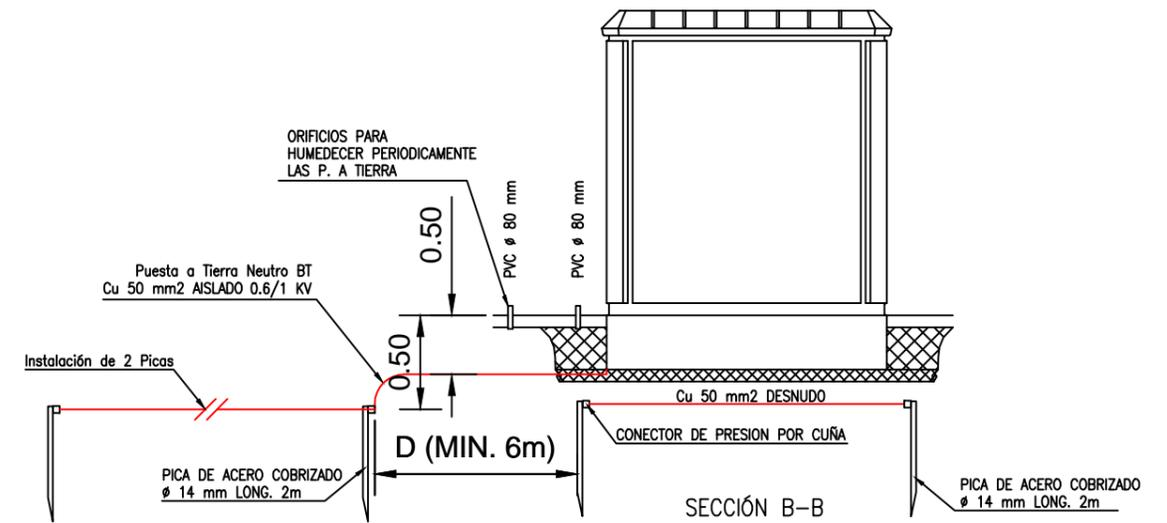
PUESTA A TIERRA DEL NEUTRO DE BAJA TENSION: El embarrado de neutro del cuadro de baja tension se conectará con dos picas alineadas, debiéndose garantizar que la resistencia total de puesta a tierra del neutro de la red de distribución de baja tension sea inferior a 37 Ohm.
