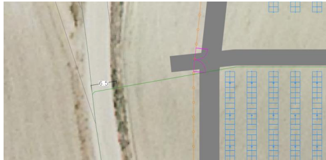
Figura 4.1.17.a Cruzamiento de camino público. Fuente: Proyectos de Ejecución Planta Fotovoltaica Venta Angulo, Los Llanos y Las Canteras. T.M. Caniles (Granada).
