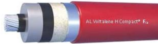
Imagen 27. Cableado RH5Z1-OL
