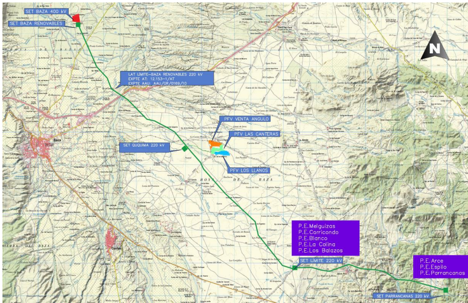
Imagen 4. Instalaciones colectoras de evacuación hasta el punto de conexión con la RdT.
