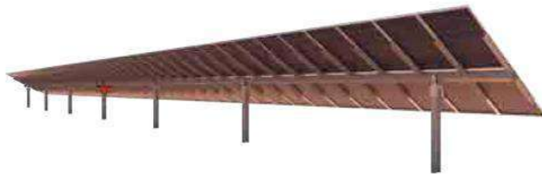
Figura 10. Estructura metálica seguidor.
