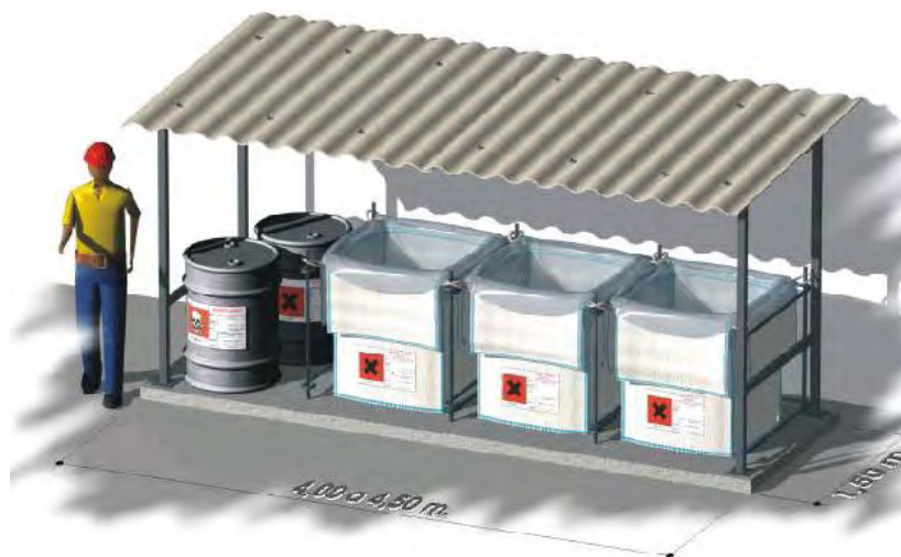
Detalle almacén punto limpio.
