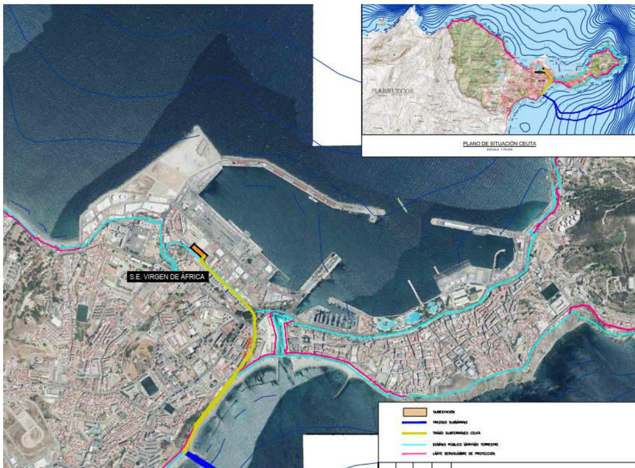
Trazado subterráneo lado Ceuta desde SE Virgen de África hasta aparcamiento asfaltado playa de El Chorrillo en zanjas de simple y doble circuito.
