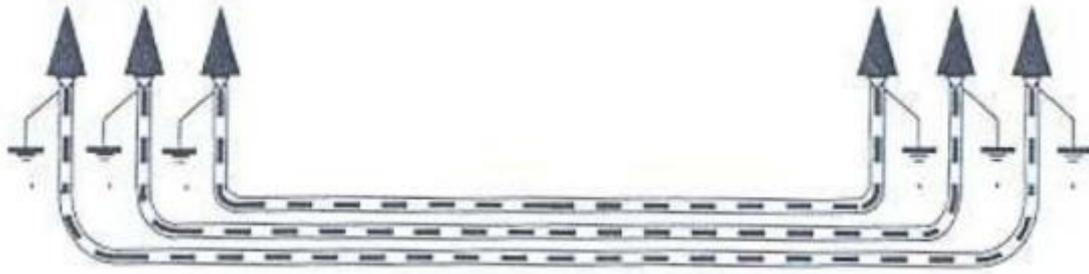
**Figura 25. Puesta a tierra de cubiertas metálicas.**
