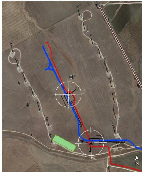
Imagen 3 Disposición de los 2 nuevos aerogeneradores Nordex 163/6X de 7000 kW proyectados. En color azul los caminos propuestos para su instalación y de color verde, la campa de acopio para desmontaje de antiguos aerogeneradores.
