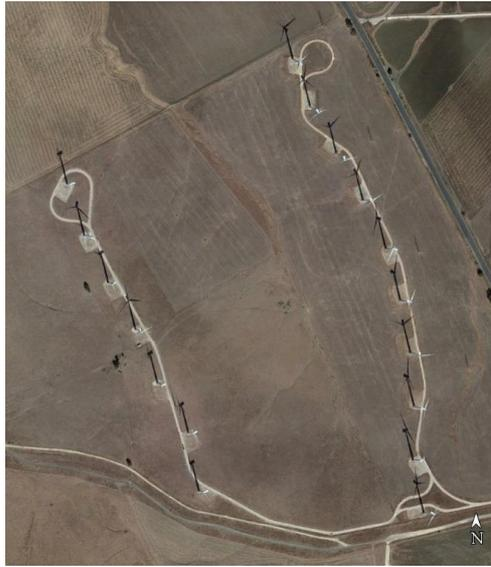
Imagen 2 Disposición actual de los 17 aerogeneradores MADE de 800 kW del parque eólico Cortijo de Iruelas.
