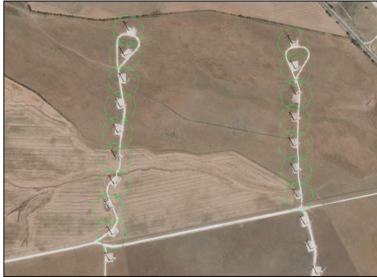
Imagen 2 Disposición actual de los 16 aerogeneradores S-800 de 800 kW del parque eólico Río Almodóvar.
