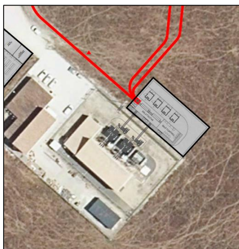
Imagen 7 Detalle de zona de ampliación de la subestación El Gallego.
