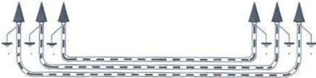
Figura 25. Puesta a tierra de cubiertas metálicas.
