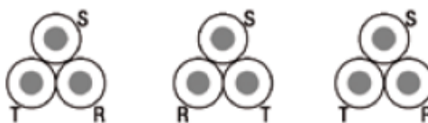
Figura 24. Colocación de cables en tresbolillo.
