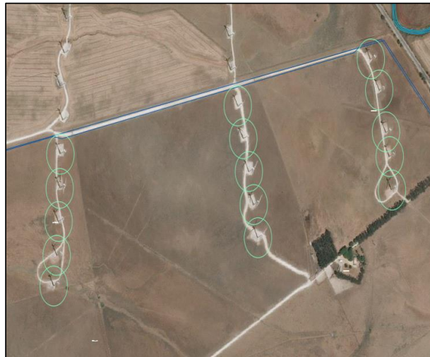
Imagen 2 Disposición actual de los 15 aerogeneradores S-800 de 800 kW del parque eólico La Manga
