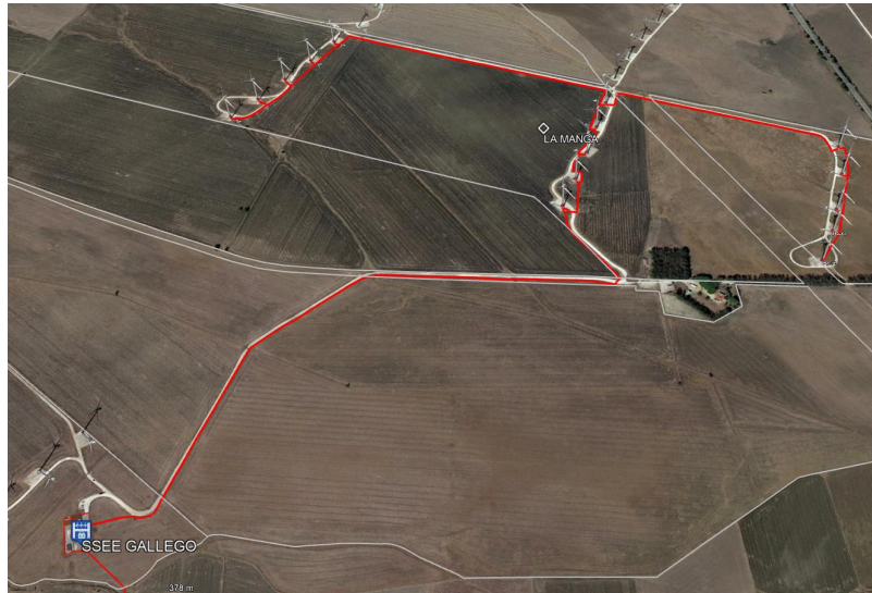
Imagen 13 Configuración de zanjas previa a 20 kV.
