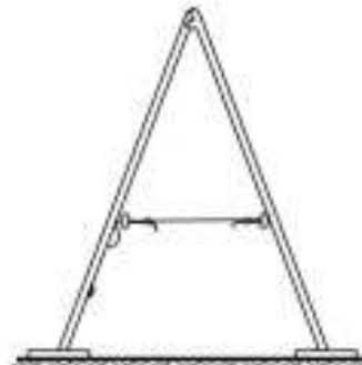
LAS ESCALERAS DE TIJERA DEBEN DISPONER DE CUERDA O CADENA Y DE ZAPATAS ANTIDESLIZANTES
