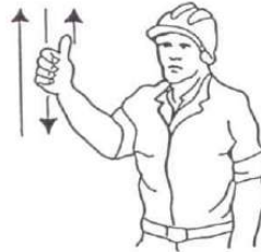
4 Levantar el aguilón o pluma lentamente
