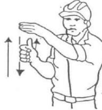
4 Levantar el aguilón o pluma lentamente
