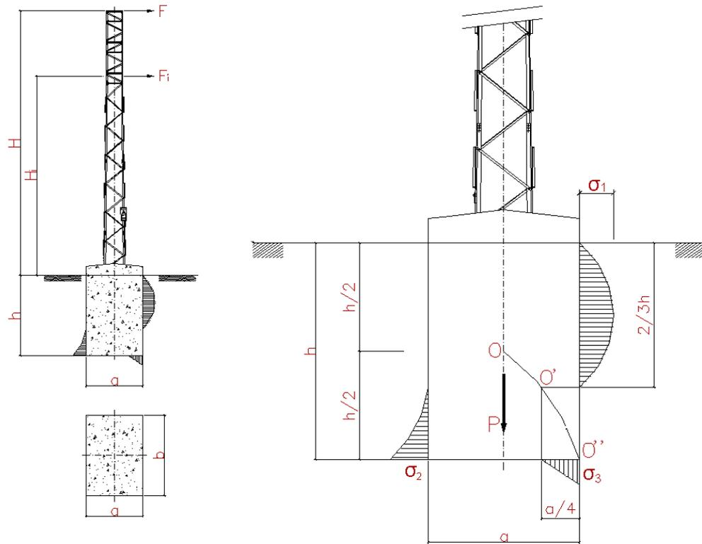
Para otros tipos de terreno el centro de giro O' varía entre el punto O en el eje de la cimentación, para terrenos muy blandos, y el punto O'' en el borde de ésta, para terrenos muy duros, tipo roca.
