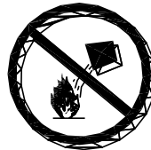
PROHIBIDO APAGAR CON AGUA
