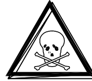
RIESGO DE INTOXICACION
