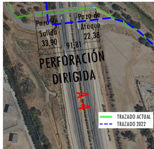
Imagen 3: Perforación dirigida A-4
