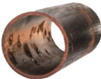
Corrosión por oxígeno disuelto en el agua
