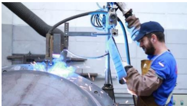
Soldadura de las tapas y accesorios mediante robot de soldadura
