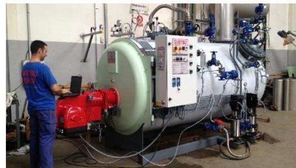
Pruebas de rendimiento y consumo de todas las calderas fabricadas.
