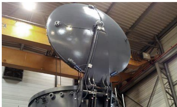
Sistema centrador para el ajuste de la apertura de tapa
