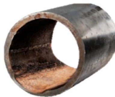
Corrosión superficial debido a \text{CO}_2
