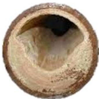
Depósitos calcáreos en el interior de la caldera
