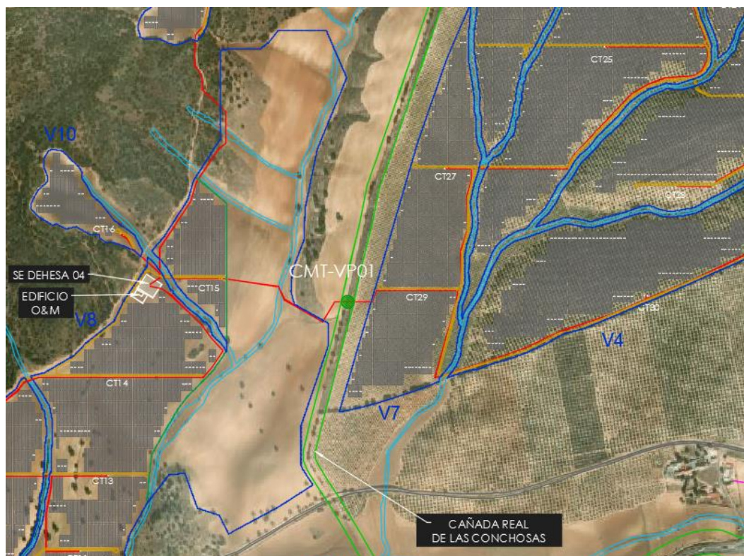
Imagen 6. Ubicación del cruce de la línea MT con la vía pecuaria.
