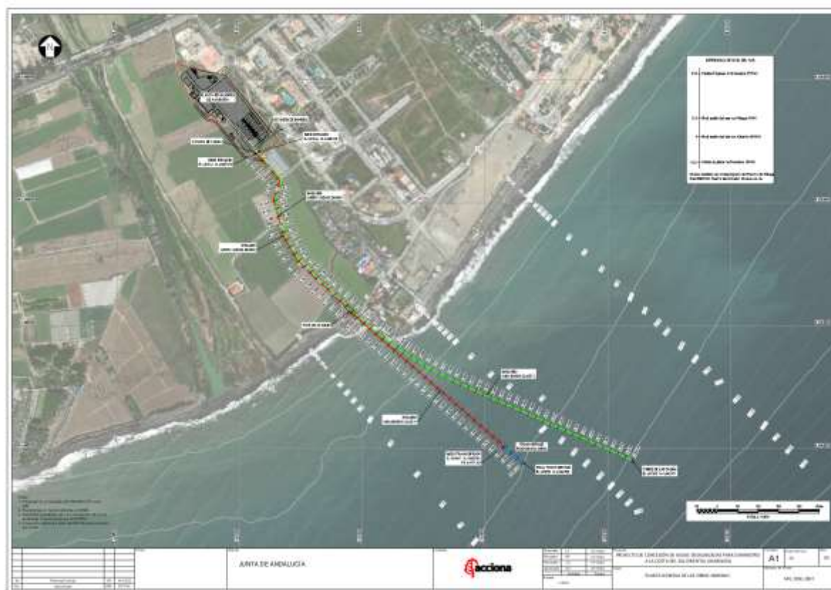
Imagen 9: Trazado de las tuberías de agua de mar (verde) y salmuera (rojo)
