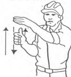
4 Levantar el aguilón o pluma lentamente
