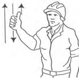
4 Levantar el aguilón o pluma lentamente
