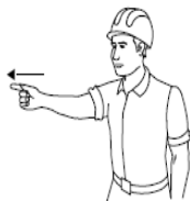
11 GIRAR EL AGUILÓN EN LA DIRECCIÓN INDICADA POR EL DEDO
