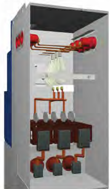
Ejemplo de interruptor automático con mecanismo de maniobra AV
