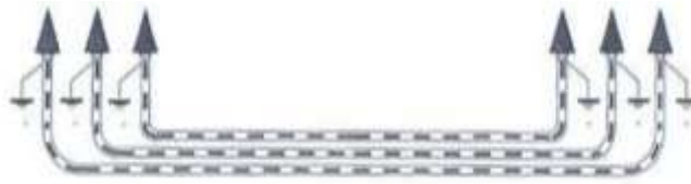
Ilustración 20. Puesta a tierra de cubiertas metálicas
