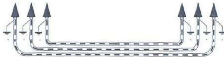
Ilustración 36. Puesta a tierra cubiertas metálicas
